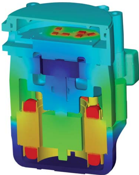
4 CFD-Analyse einer elektrisch angetriebenen Ölpumpe mit typischer Temperaturverteilung
