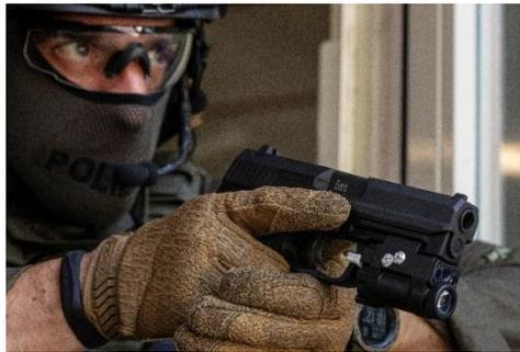
Das neu entwickelte Modul bietet bei kompakten Ausmaßen (L/B/H 76 x 45 x 30 mm) und einem Gewicht von nur 115 g eine hohe Laserleistung bis zur Laserklasse 3B, die permanent über eine Monitordiode kontrolliert und elektronisch geregelt wird. Das Anbaumodul verfügt über eine Dongle-Schnittstelle zur Leistungsanpassung für einen augensicheren Trainingsmodus sowie effektives Force-on-Force-Training.
