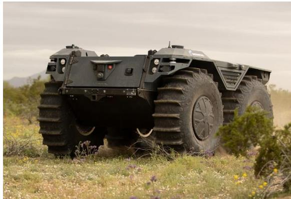
Der Mission Master SP ist ein kompaktes UGS mit signaturarmem Elektromotor und amphibischen Fähigkeiten und bietet damit einen unschätzbaren Vorteil, wenn es auf Geräuschlosigkeit ankommt. Die größeren Rheinmetall Mission Master CXT und XT Fahrzeuge können sowohl auf Eis und Schnee als auch auf sandigem, felsigem und bergigem Gelände eingesetzt werden. Ihre fortschrittlichen amphibischen Fähigkeiten erlauben es ihnen, zu schwimmen, während sie ihre volle Nutzlast von 1000 kg beibehalten können.
