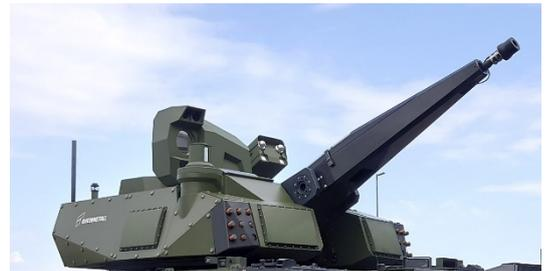
Rheinmetall Laserquelle auch bei hoher Leistung mit hoher Präzision auf das Ziel auszurichten. Dank der ausgeklügelten Mechanik kann der Luftraum um die Trägerplattform zu 100% abgedeckt werden. Laserleistungen von 20 bis 50 kW sind in einer ersten Realisierungsphase angedacht.
