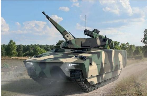
heraus bedient. Ein hoher Grad an Automatisierung unterstützt die Besatzung bei Lagewahrnehmung, Zielverfolgung und -identifizierung. Über eine ballistisch geschützte Turmluke kann die Besatzung einen Blick ins Gelände. Weiterhin ermöglicht die Luke den Zugriff auf Kanone, Magazin oder Elektrooptische Sensorik zu Wartungszwecken oder zum Nachladen.
